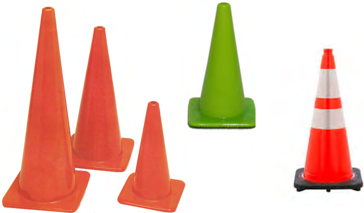
TRAFFIC CONES, AVAILABLE IN ORANGE OR GREEN WITH REFLECTIVE COLLARS HEIGHT (WEIGHT) CHOICES 36"(10#) 28"(10#) 28"(7#) 18"(5#) 18"(3#) 12"(1.5#)
